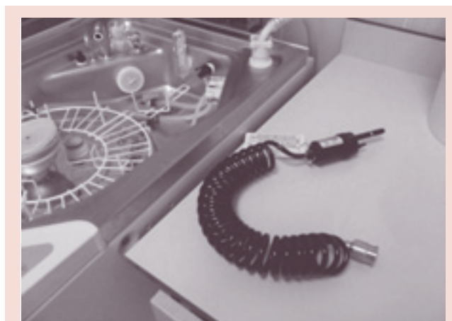
Рис. 2. Тест на герметичность эндоскопа
