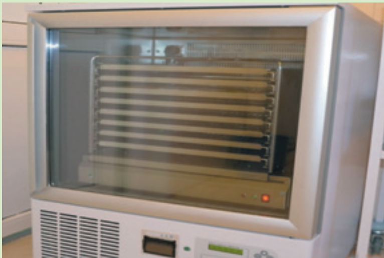
Рис. 6. Перемешиватель тромбоцитов с климатической камерой
