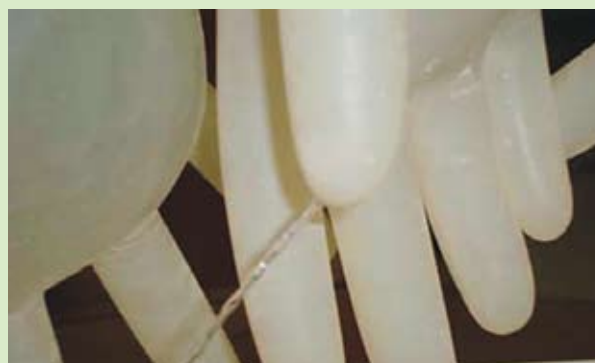
Рис. 2. Обнаружение микроповреждения перчатки при наполнении водой
