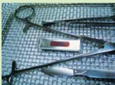
Рис. 1. Индикаторы «TOSI®» для определения эффективности автоматизированной мойки инструментов
