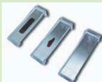
Рис. 3. Идентификация проблем с отмывом – наглядная и абсолютно достоверная
